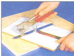
Регулируемая направляющая позволяет нарезать любое количество одинаковых плиток.
