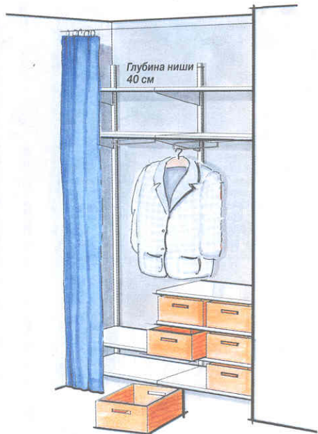
Парные кронштейны следует крепить на одной и той же высоте, проверяя их положение с помощью уровня.
